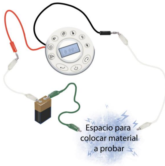
Figura 3. Circuito que incluye Labdisc y un espacio para colocar el material a probar
