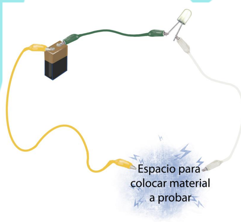
Figura 2. Circuito que incluye LED y un espacio para colocar el material a probar
