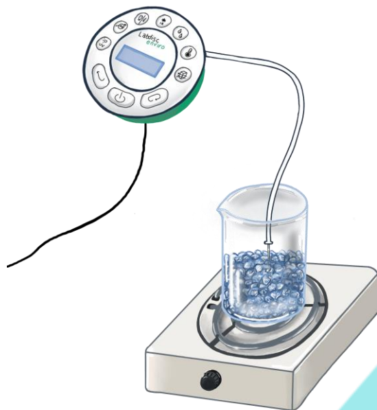
Figura 3. Colocación del dispositivo experimental. Nota que la sonda está completamente cubierta por el hielo
