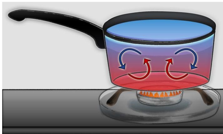
Figura 3. Corrientes de convección dentro de una olla con agua hirviendo
